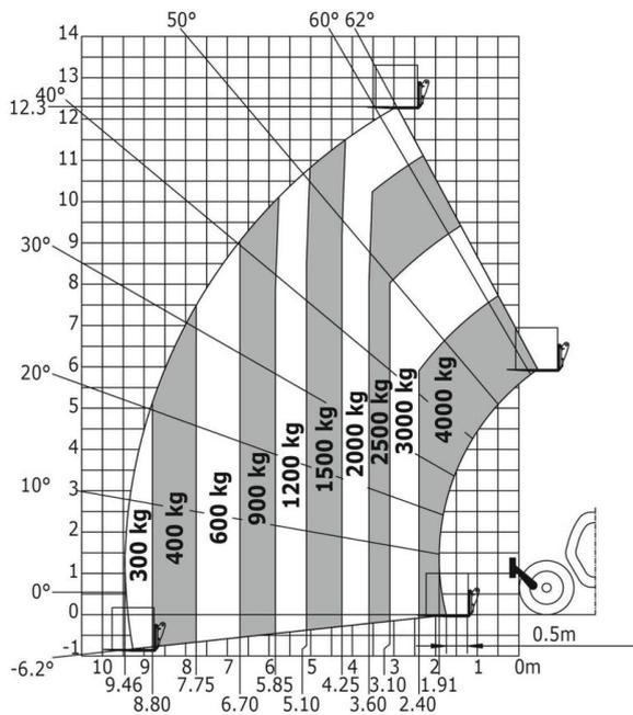
Máquina sobre estabilizadores con horquillas
